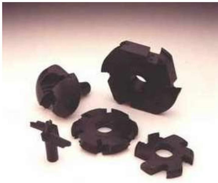
**Рис. 2. Внешний вид деталей, полученных методом холодного чернения**
