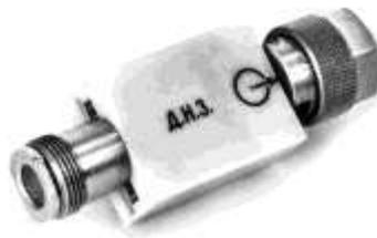
**Рис. 16. Внешний вид формирователя импульсов на туннельном диоде**
