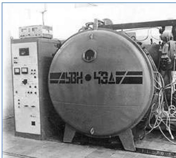
**Рис. 1. Установка вакуумная напылительная УВН-4ЭД электродуговая**
