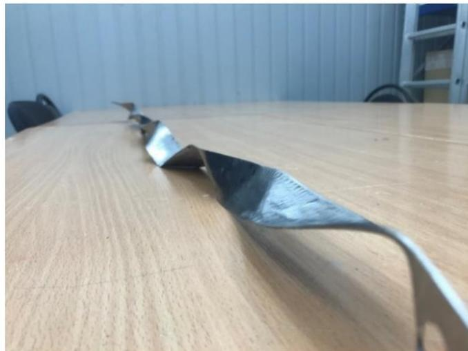
**Рис. 2. Ленточный завихритель экспериментальной модели**
