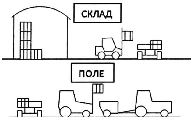
Рис. 5. Система транспортировки семян картофеля с помощью контейнеров.
